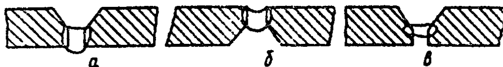
Рис. 18.7. Дефекты корня шва:
